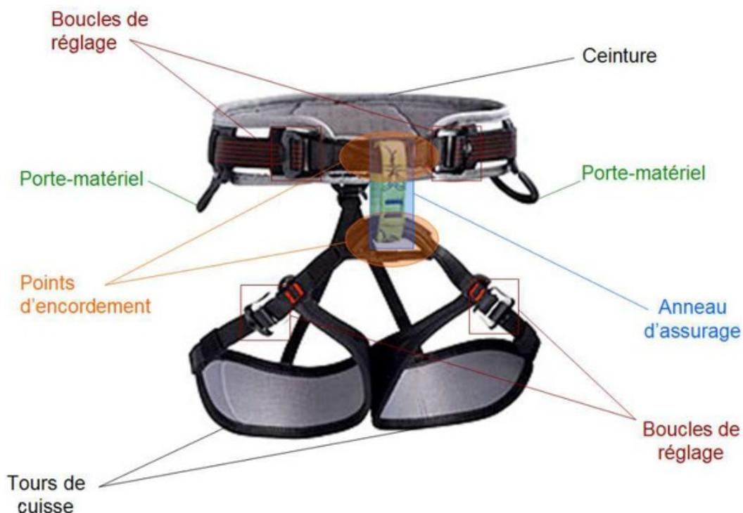
On voit clairement que le baudrier est composé de différents équipements. Seuls l'anneau d'assurage ou encore les points d'encordement dits les pontets peuvent servir à l'installation des longes à absorber d'énergie.
